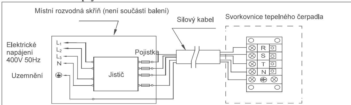
Poznámka: pro bezpečné použití v zimě se důrazně doporučuje použít funkci priority ohřevu. Podrobné schéma elektrického zapojení viz příloha 1.
