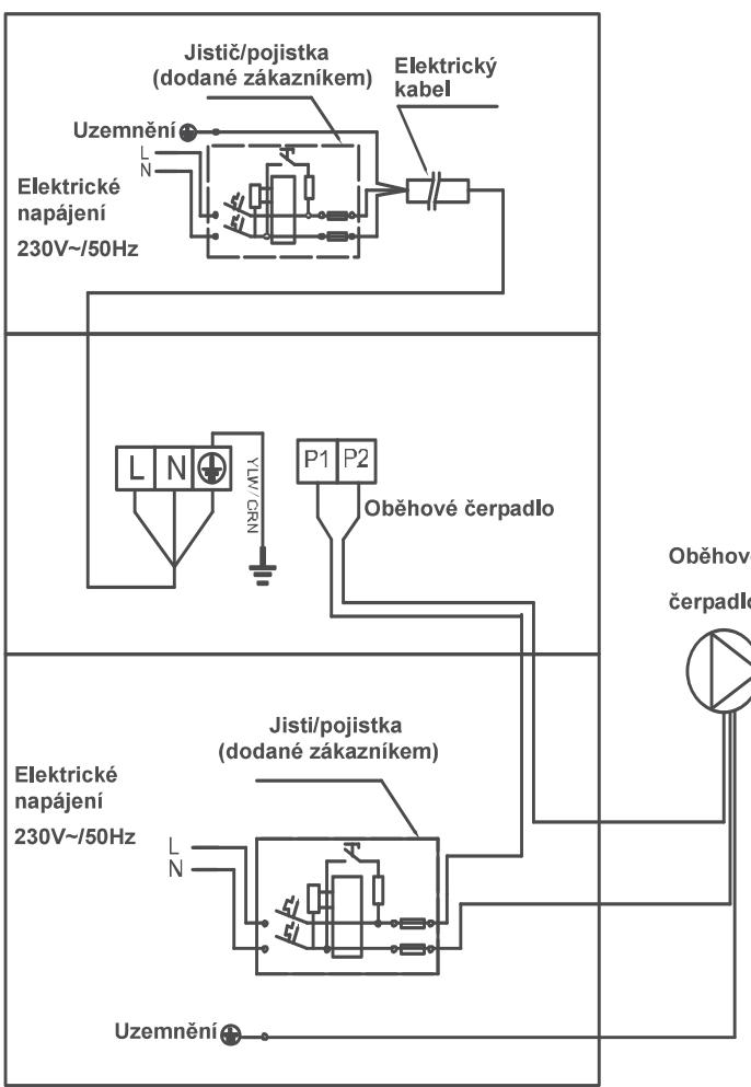
Pro oběhové čerpadlo napětí 230V, Kapacita >500W
