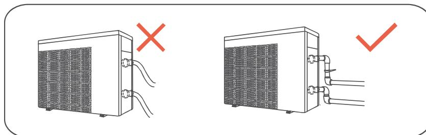
2.1.2. Pro zajištění topné účinnosti musí být délka vodního potrubí mezi bazénem a tepelným čerpadlem  $\leq 10\text{m}$ .
