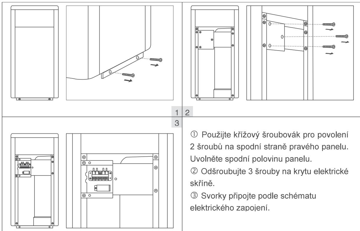
**Poznámka:** u modelu IPHC20-35 otevřete pro elektrické připojení zadní panel. Postup je stejný jako výše.
