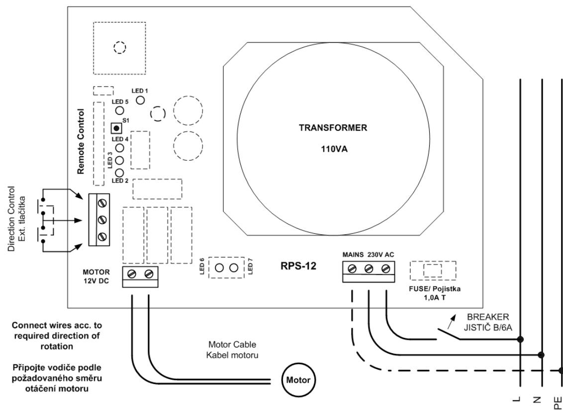
Motor lze spouštět pomocí dálkového ovládání (DO) nebo externím dvojitým tlačítkem. Vypnutí motoru lze provést kterýmkoli tlačítkem.
