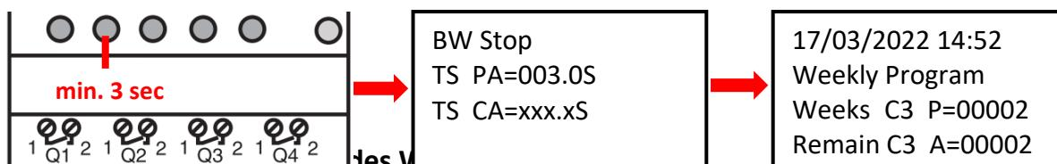
Halten Sie die Tastenkombination **◀ + ▲** gedrückt. Es erscheint ein Bildschirm mit einem Countdown von 3 Sekunden bis zum Beginn des manuellen Waschens - nach 3 Sekunden beginnt die Druckaufbau des Kompressors (**TT5**):
