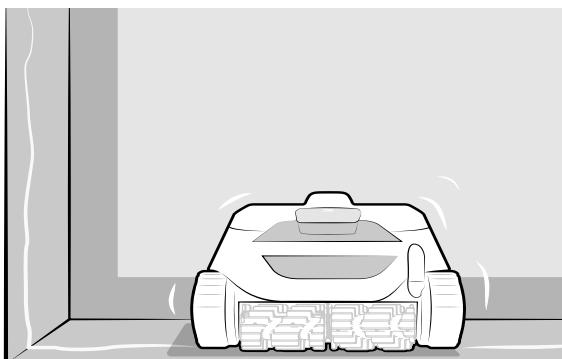
**2** Robot vytáhněte za rukojeť úplně z vody. Robot vystřikuje vodu zadní tryskou, aby byl lehčí.
