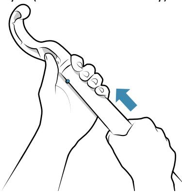
**3** Zachyťte hákem rukojetí robotu a vytáhněte ho na hladinu
