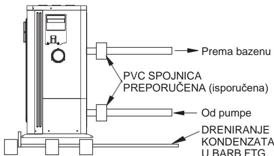
Kondenzacija: s obzirom da toplinska pumpa zrak hlađi na 4 – 5 °C, na rebrima isparivača u obliku potkove može se kondenzirati voda. Kod visoke relativne vlažnosti kondenzat može iznositi i nekoliko litara u satu. Voda teče niz rebra posude za prihvatanje kondenzata od kuda otjeće preko spojnog elementa odvoda na bočnoj strani posude.
