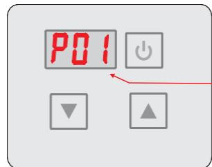
Ulasna temperatura vode. Pogreška na senzoru.
