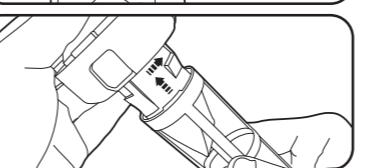
Den Saugkopf in das untere Ende des Saugrohres einsetzen.
