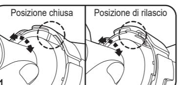
2. Afferrare la fascia in plastica alla base del cestello (NON AFFERRARE LA RETE DEL CESTELLO FILTRO!). Ruotare in senso antiorario finché non si ferma. Poi tirare delicatamente il cestello filtro per separarlo dalla bocchetta di raccordo.
