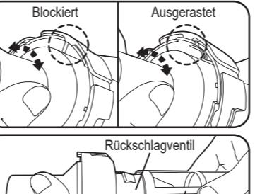
Einbau des Filterkorbes in den Saugkopf Die Noppen im Filterkorb passgenau mit dem Rückschlagventil verbinden und dann den Filterkorb im Uhrzeigersinn verdrehen bis er einrastet.
